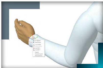
Manipolate facilmente la postura del manichino utilizzando la funzionalità standard di Creo Parametric e una libreria completa di macro posture (in piedi, con trazione, spinta, portata) e micro posture (posizionamento di braccia, mani, dita e piedi). Create posture personalizzate e sfruttate un'esperienza utente semplificata e migliorata per la manipolazione del manichino.
