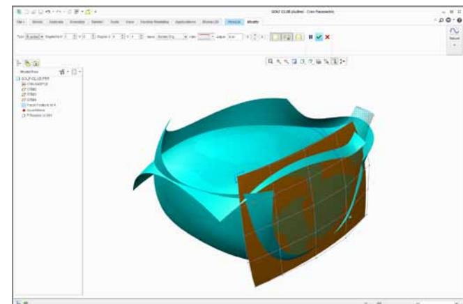
如有必要，也可以完全控制曲面控制网格，以手动生成曲线和曲面定义。
