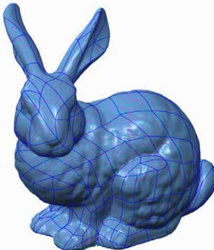
利用 Creo Reverse Engineering，您无需拥有原始的 CAD 文件即能捕捉重要的数据。上图显示了从兔子的扫描点云中得到的小平面模型。验证工具确保了所得到的 CAD 模型准确表示了扫描的数据。最终，我们就得到了完整的模型。
