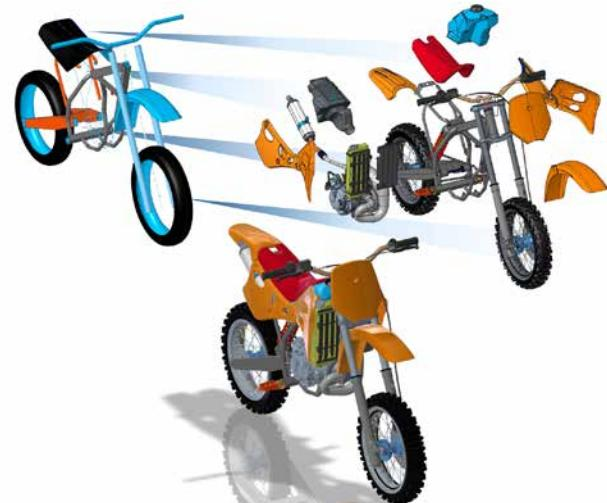
Creo AAX 提供高级装配功能（例如骨架模型和数据共享功能），以支持自顶向下设计。可以轻松地将与装配相关的标准传递给同时执行设计工作的团队。
